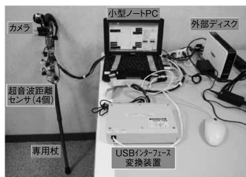
図8 システムの全体写真
